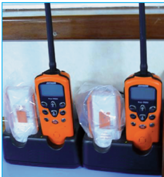
Figura 4. Equipos portátiles tipo SMSSM con batería primaria.
