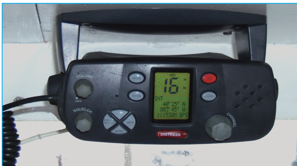
Figura 1. Equipo de VHF de LLSD de clase D.
