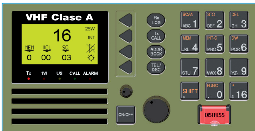
Figura 2. Equipo de VHF de LLSD de clase A.
